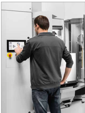
HS flex mit zwei Palettenspeichermusername und Rüstplatz, adaptiert an ein Bearbeitungszentrum C 42 U.
