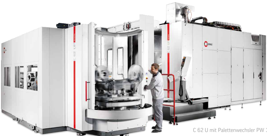
Palettenwechsler PW 150 8-fach Speicher
