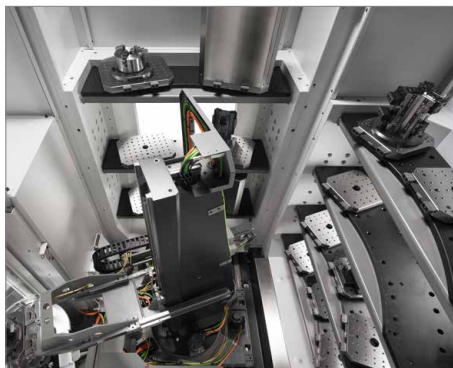
HS flex mit zwei Palettenspeichermusername und Rüstplatz, adaptiert an ein Bearbeitungszentrum C 42 U.
