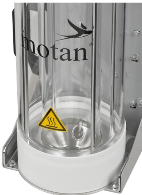
Detalhe da entrada de ar seco e distribuidor de ar
